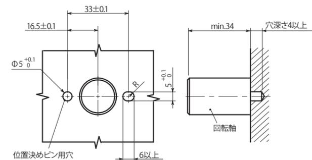
※ 2つの位置決めピン用穴のうち、どちらか一方は図のような長穴にしてください。長穴加工が難しい場合は $\Phi 6$ 以上の丸穴にしてください。
