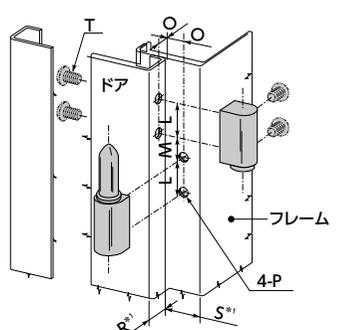
\*1: ドアを180°開くようにするためには、R寸法またはS寸法のいずれか一方を、25.4mm以下にしてください。
