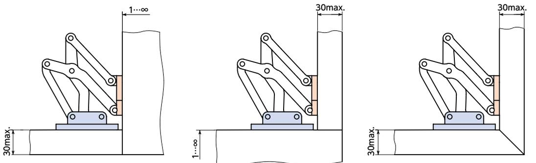
● 表示されている設計バリエーションは、標準的な設置条件を表しています。パネル厚さや取り付け位置により最大パネル厚さは変化します。
