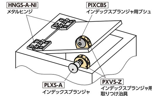
● 適用インデックスプランジャ用取り付け治具
