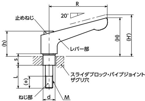
\*ねじ部の長さはスライダブロック・パイプジョイントへの取り付け用の専用設計となります。
