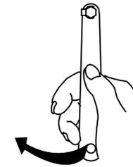
ねじの上部に作業スペースがある場合は、ビット部を押さえつけることで安定して作業ができます。
