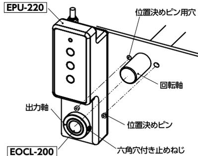
② EPU-210 または EPU-220 の出力軸のねじ穴と EOCL-200 のねじ通し穴の位相を合わせ、EOCL-200 に付属の六角穴付き止めねじを取りつけてください。
