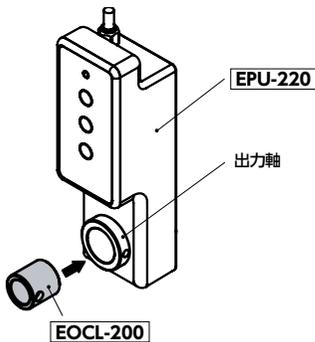
③ EOCL-200 を取りつけた状態で EPU-210 または EPU-220 の出力軸に回転軸を通し、六角穴付き止めねじで固定してください。(推奨締めつけトルク: 2.8N・m)
