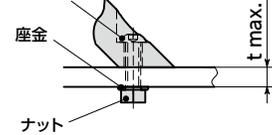
付属の六角穴付きボタンボルト・ナット・座金を使用してパネルなどに取りつける場合、パネルの厚さはt以下にしてください。
