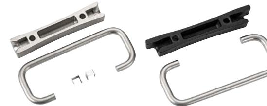
ベースと取り付け面で取っ手をはさみ込むようにして、ボルトで固定してください。取っ手をベースにはめ込んだだけでは、取っ手は固定されません。
