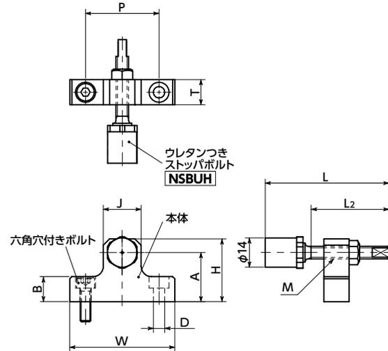
\*: 取り付け面からテーブル上面までの距離をもとにA寸法を確認し、選定してください。
