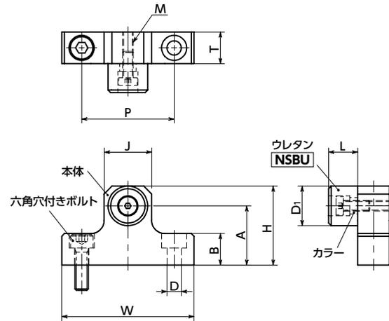
\*: 取り付け面からテーブル上面までの距離をもとにA寸法を確認し、選定してください。
