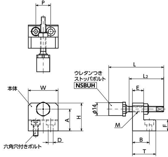
\*: 取り付け面からテーブル上面までの距離をもとにA寸法を確認し、選定してください。
