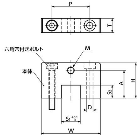
\*: 取り付け面からテーブル上面までの距離をもとにA寸法を確認し、選定してください。
