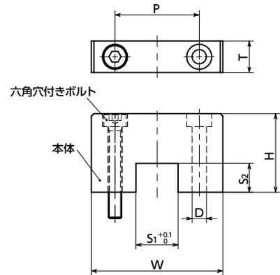
\*: 取り付け面からテーブル上面までの距離をもとにH寸法を確認し、選定してください。
