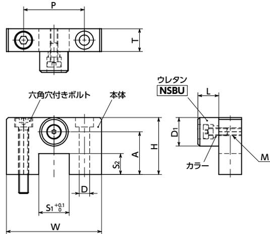
\*: 取り付け面からテーブル上面までの距離をもとにA寸法を確認し、選定してください。
