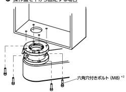
操作盤を六角穴付きボルト (M8) 4 本\*2 で 固定します。
