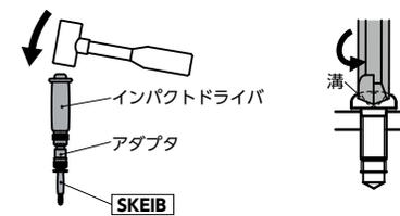
\*1: **SKEID** のアダプタを軽く押し込みながら回し、ねじをゆるめる方向に△マークを合わせてください。L左回転・R右回転
