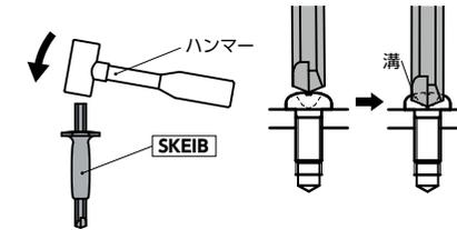
② **SKEIB** をインパクトドライバ **SKEID** に取りつけます。**SKEIB** の先端をねじ頭部に作った溝に垂直に当て、**SKEID** のグリップ部をしっかり握り、後端をハンマーで叩くと、**SKEID** の先端が最大45°回転\*1し、ねじがゆるみます。
