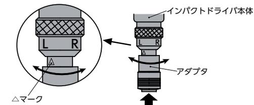
● 打撃の衝撃によって **SKEID** の回転方向が切り替わることがあります。その場合は、回転させたい方向に力を入れながらハンマーで叩いてください。
