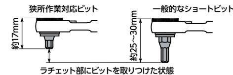
● ラチェット機構により、ねじのリセスにビットを差し込み直す必要がなく、連続してねじ回し作業が行えます。歯数52のラチェット部は、約7°間隔でハンドルを往復させることができ、回転方向の狭所作業にも適しています。
