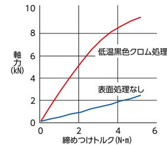
● 六角穴付きボルト (SUSXM7製・低温黒色クロム処理) SNSS-M5-25-RY での参考データになります。
